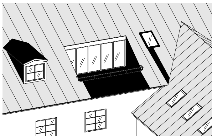
25. Axonometri som visar taklandskap med indragen takterrass.
